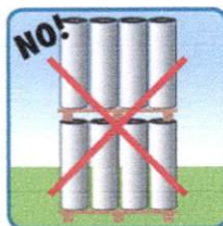
Evitar solapamientos de los palés sin una adecuada repartición de la carga.
