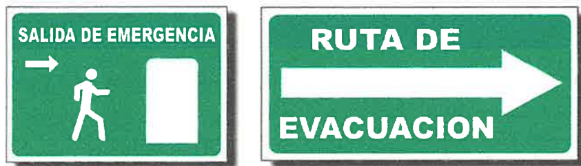
Figuras 4.4.5.1-1. Tipo de señalización de salida de emergencia.
