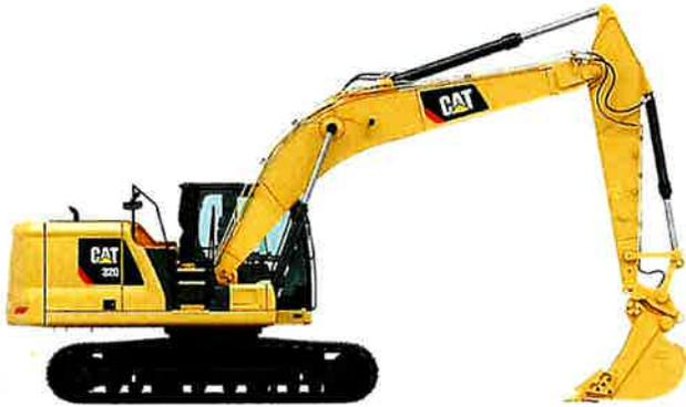
Una excavadora es una máquina empleada para la excavación y movimiento de tierras u otros materiales. La excavadora se considera un vehículo autopropulsado porque se puede desplazar de un lugar a otro, pero esta no es su función principal.
