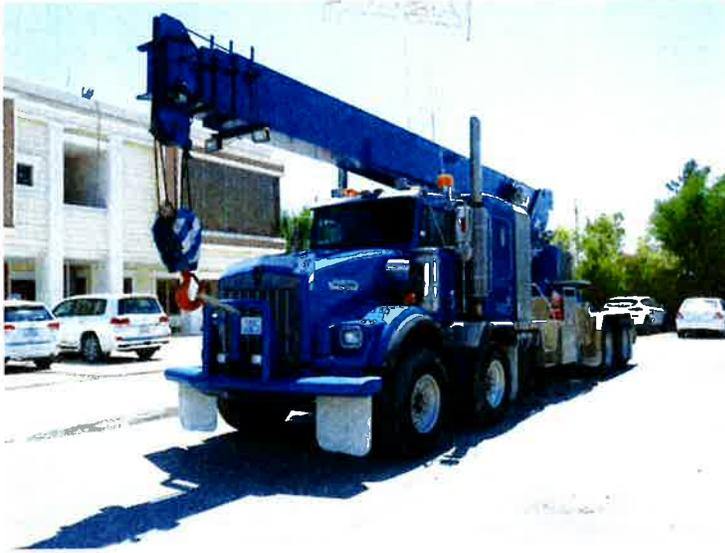
Se utiliza generalmente para la manipulación de cargas, por ejemplo, para transportar materiales pesados. Este vehículo es indispensable en el sector de la construcción ya que permite la elevación, carga y descarga de todo tipo de piezas y materiales hacia y desde el propio vehículo.
