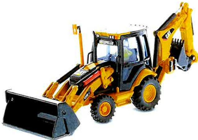
Una retroexcavadora es un equipo que posee una cuchara cargadora en la parte frontal. Este cucharón tiene una gran capacidad de carga y puede empujar, nivelar, recoger y cargar diferentes materiales. Al mismo tiempo, el equipo posee en la parte posterior un brazo excavador para cavar.
