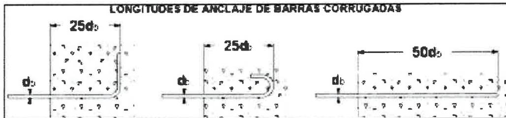
Longitudes de solape: La longitud mínima de solape para que se transfiera por adherencia la resistencia máxima de una barra corrugada de refuerzo es de  $50d_b$ .
