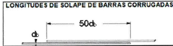
La longitud de solape para que se transfiera por adherencia la resistencia máxima de los alambres de una malla electro soldada debe contener dos alambres transversales, sin ser menos de 25 cm.
