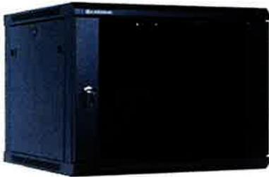
El **WCC07-66-BAA-C** es un gabinete de pared tipo rack abatible de 7U, fabricado en acero laminado en frío con tratamiento desengrasante y acabado electrostático (RAL 9004, negro), el cual cumple los estándares internacionales ANSI/EIA RS-310-D, DIN 41491, IEC 297-2 y ETSI para montaje de equipos de 19".
