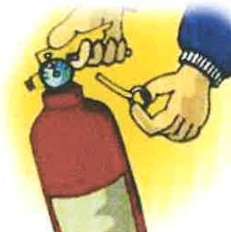
**la palanca de accionamiento del extintor.**
