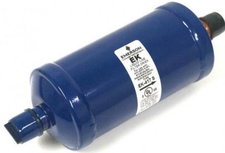
El filtro EK para línea de líquido es un filtro deshidratador de desecante protegido por un filtro inicial de fibra de vidrio de 40 micrones para eliminar la mayoría de los contaminantes sólidos y lodos y un filtro final para partículas de hasta 20 micrones para eliminar toda contaminación existente. De este modo, el sistema de refrigeración permanecerá limpio por mucho más tiempo con una caída de presión mínima en el filtro deshidratador.
