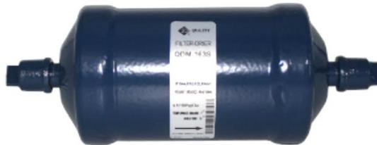
Los filtros secadores moleculares de línea de líquido cuentan con: conexión de cobre para soldadura, conexión de acero para abocinar, todos los filtros cumplen con los estándares de desecantes y están tratados para ser resistentes a la corrosión, compatibles con refrigerantes: R12/R22/R502/R507A/R134A/R404A/R407C/ R410A, MWP 610 PSIG/42 bar, temp. rango: -40 a 160 ° F / -40 a 160 ° C, y están registrados por U
