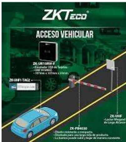
UHF en el parabrisas, se enviará la identificación al panel de control de acceso y este emitirá una apertura o un rechazo de la solicitud, todas estas informaciones se almacenan en el panel de control de acceso y luego se recuperan los datos en reportes de entradas, salidas, restricciones, etc. Estos reportes pueden ser solicitados por puerta, oficina, fecha, grupos, personas individuales, etc.
