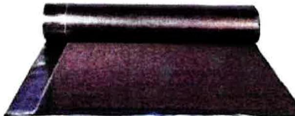
La lona asfáltica de 3 mm es un material impermeabilizante compuesto por una mezcla de asfalto modificado con polímeros y un refuerzo central de fibra de vidrio o poliéster, diseñado para proporcionar una barrera resistente contra la humedad y filtraciones en techos, cimientos y otras estructuras.
