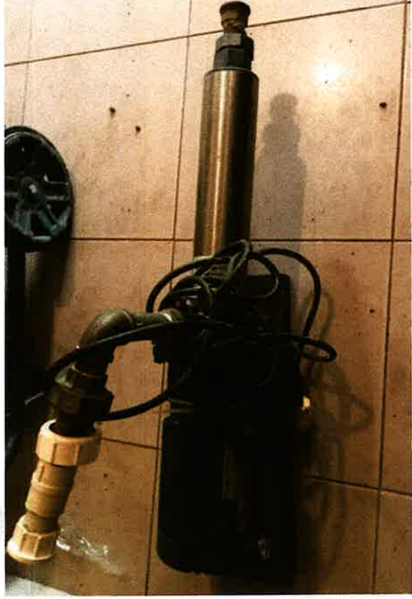
Bomba Horizontal, tipo cañón, 1 und. Para realización de prueba hidrostática.
