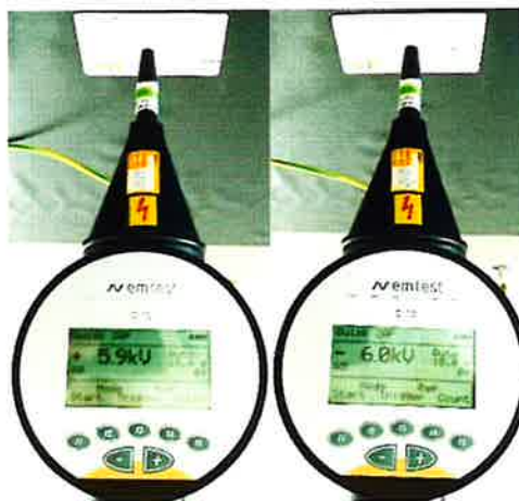
Figura 2 – Muestras bajo descargas electrostáticas
