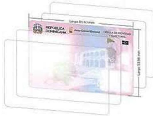
Si bien el estándar de seguridad establece un mínimo de **5 capas**, la muestra presentada ha sido fabricada con **7 capas**, lo que **supera los requisitos de seguridad** y refuerza su durabilidad estructural y sus capacidades de protección contra falsificación.
