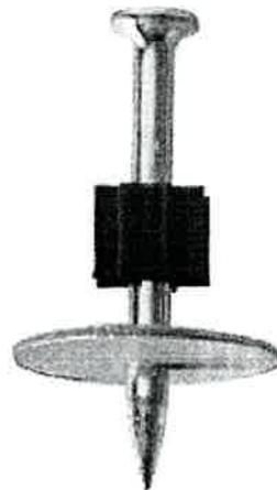
Los Clavos para pistolas de impacto cabezal de .300 "están diseñados para sujetar permanentemente un accesorio al concreto, o acero. Los clavos están formados con un vástago de 0.145 "de diámetro en varias longitudes
